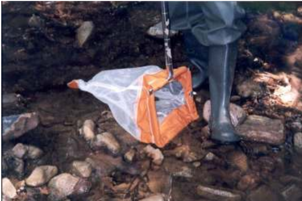
Εικόνα 70. Απόχη δειγματοληψίας βενθικών μακροασπόνδυλων σε ρέοντα επιφανειακά ύδατα.
