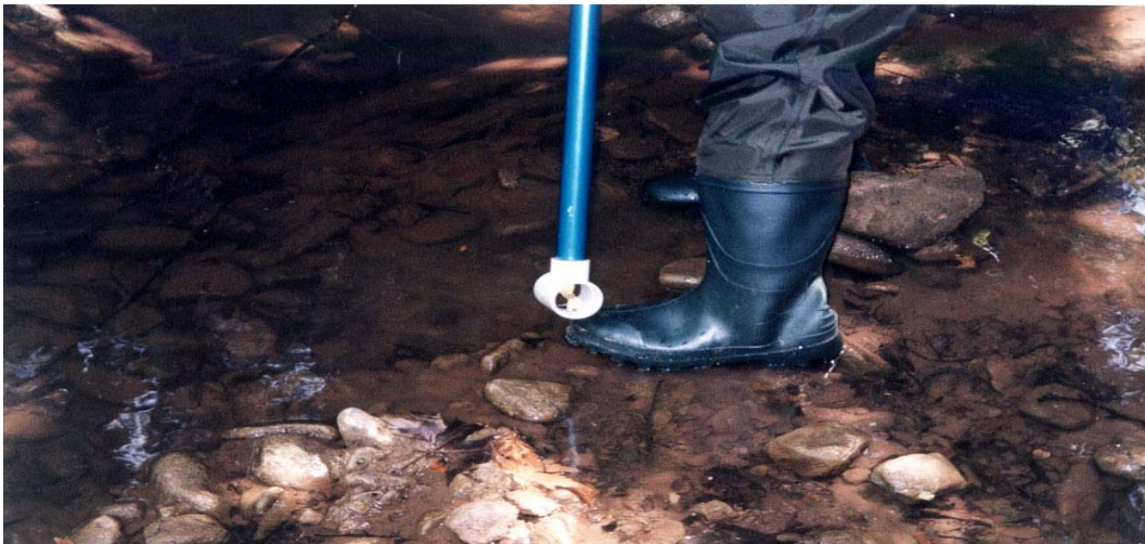
Εικόνα 11. Υπολογισμός παροχής με χρήση ροόμετρου.
