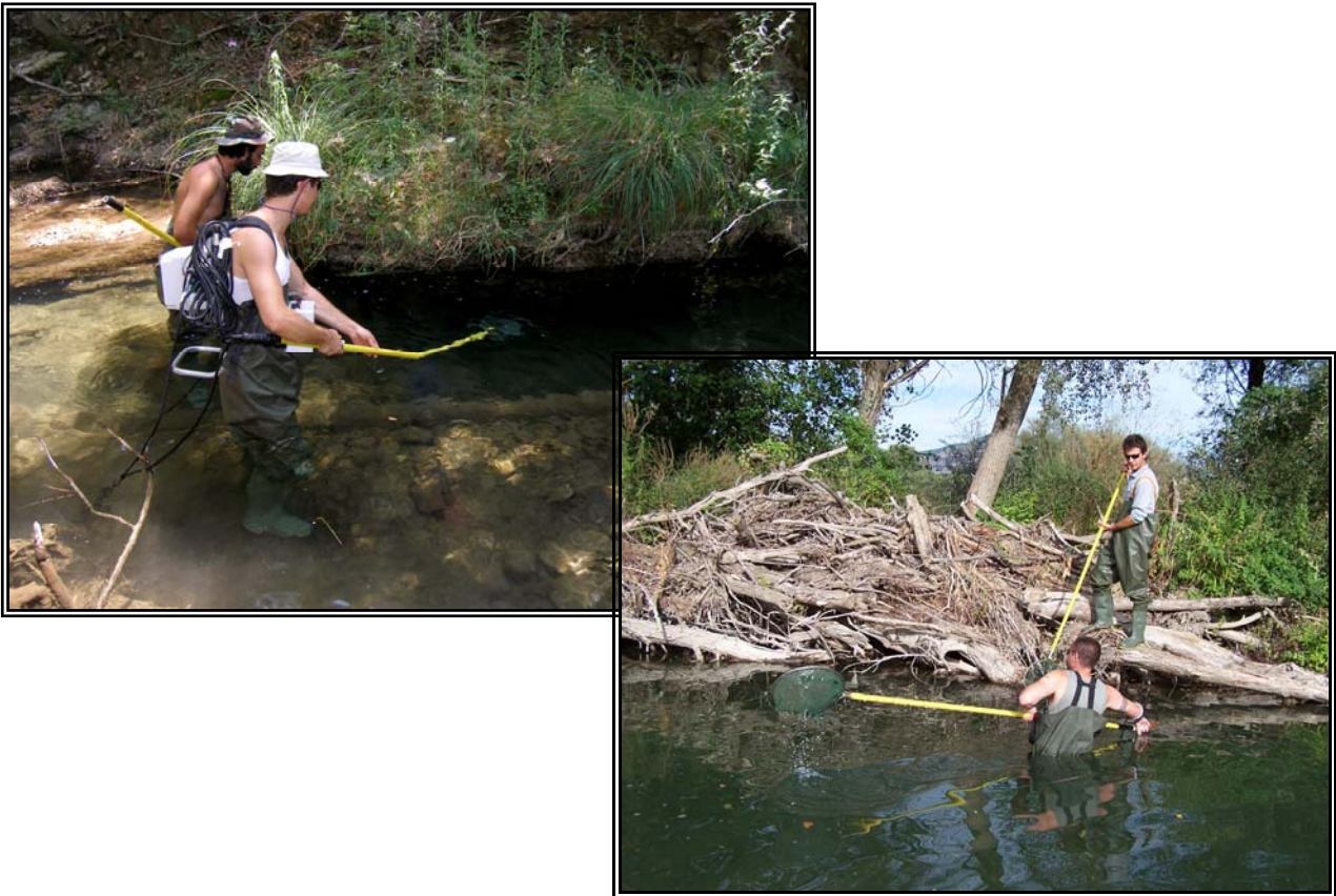
Εικόνα 6: Συλλογή ψαριών με τη φορητή (αριστερά) και με τη σταθερή συσκευή ηλεκτραλιείας (δεξιά). Η δεύτερη έχει τη δυνατότητα να συλλέγει ψάρια, ακόμη και σε μεγάλες ποσότητες νερού.
