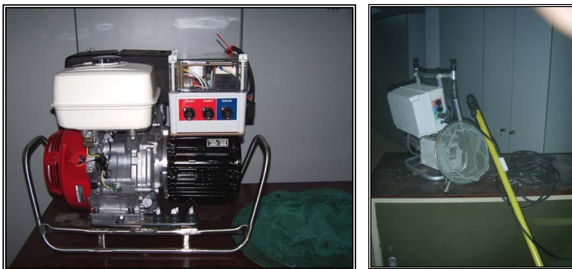
Εικόνα 5: Οι δύο συσκευές ηλεκτραλιείας που χρησιμοποιήθηκαν για τη συλλογή ψαριών. Αριστερά η συσκευή σταθερής θέσης και δεξιά η φορητή συσκευή.
