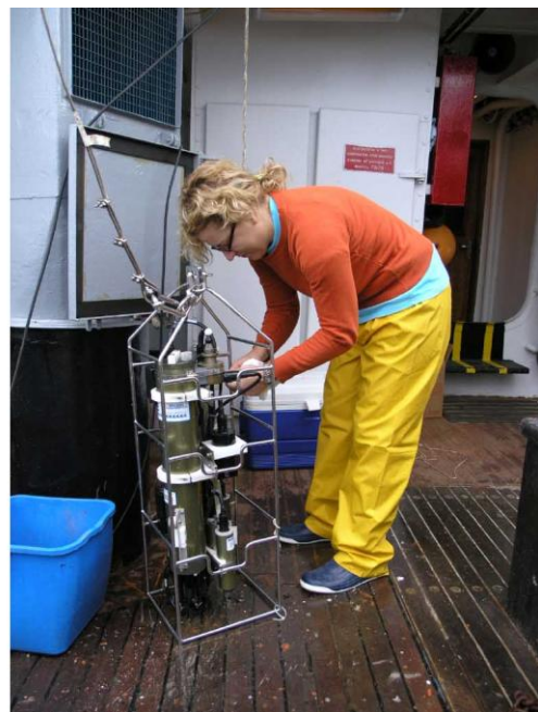
Εικόνα 16: Όργανο CTD καταγραφής περιβαλλοντικών παραμέτρων της στήλης του νερού.
