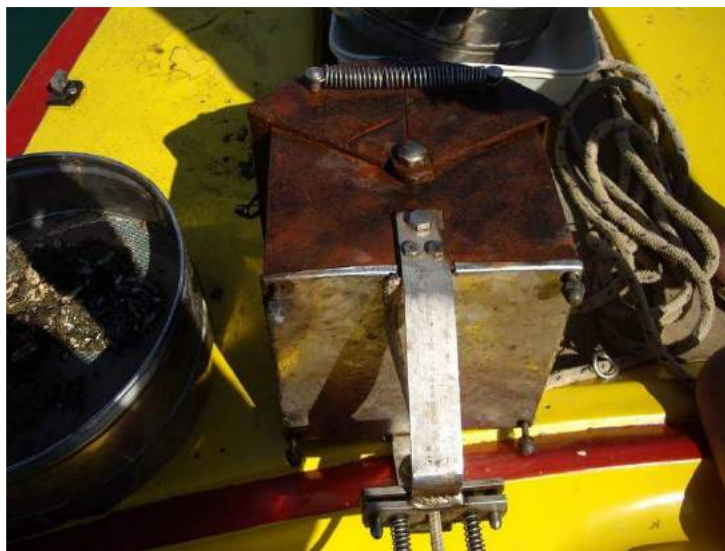
Εικόνα 107: Δειγματολήπτης τύπου Ekman και κόσκινο διήθησης βένθους λίμνης με πλέγμα διαμέτρου 1 mm.
